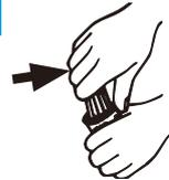
1. セット方法 HDP キャップの爪をFDCコレットのミゾへ確実にに入れてからシャンクにセットして下さい。
