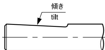
シャンク切り欠き面が傾いている工具をご使用になる場合は工具に合わせた形状のホルダを製作
