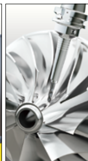
5軸の ボールエンドミル 仕上げ加工 Finishing with ball endmill on 5-axis machine
