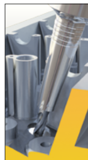
干渉のある ドリル・リーマ 加工 Drilling in tight space
