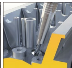
干渉のあるドリル加工 Drilling in tight space
