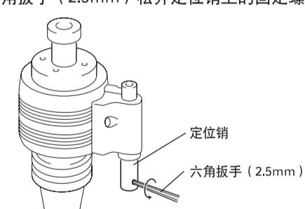
2. 将六角扳手 (5mm) 插入定位销的前端，转动，以基准线为基准，A尺寸是正值的时候将定位销伸出长度调整至比A尺寸短6mm (作动量)，A尺寸为负值的时候，将定位销的伸出长度调整至比A尺寸长6mm (作动量)。
