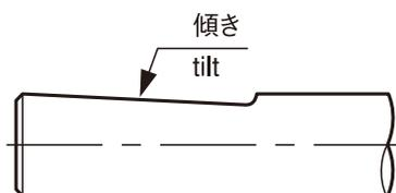
シャンク切り欠き面が傾いている工具をご使用になる場合は工具に合わせた形状のホルダを製作
